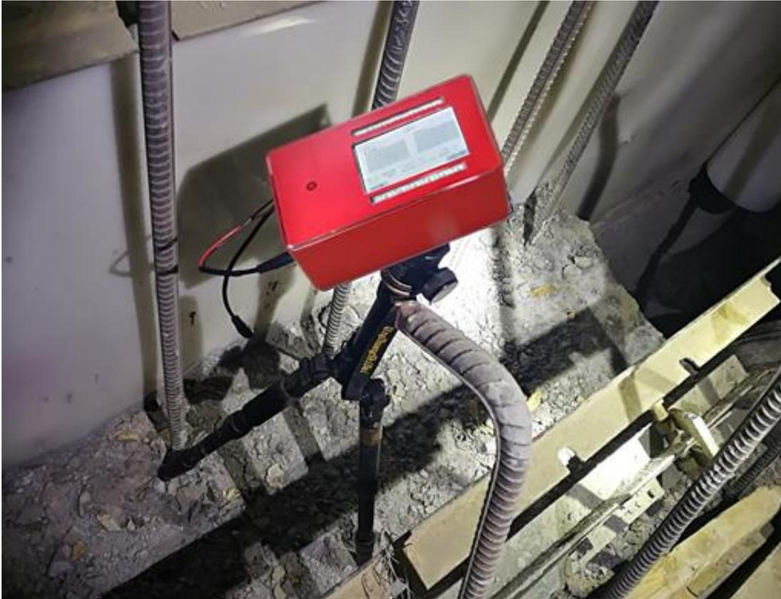
2)、设备安装至三角架的时候，每个位置的螺丝都需拧到位，防止监测过程中，随着时间的推移，监测角度发生变化而影响测量结果。
